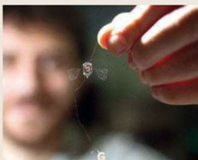
Le drone miniature Ovmi, de l'IEMN, bat des ailes mais ne peut pas décoller.
