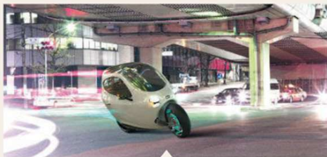
La C-1 de l'américain Lit Motors est un hybride de moto et de voiture stabilisé par un système gyroscopique.
