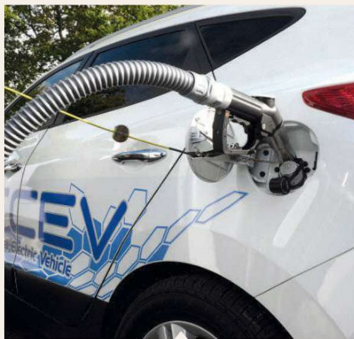
Passage à la pompe à hydrogène : en 3 minutes, le plein à 700 bars est fait.
