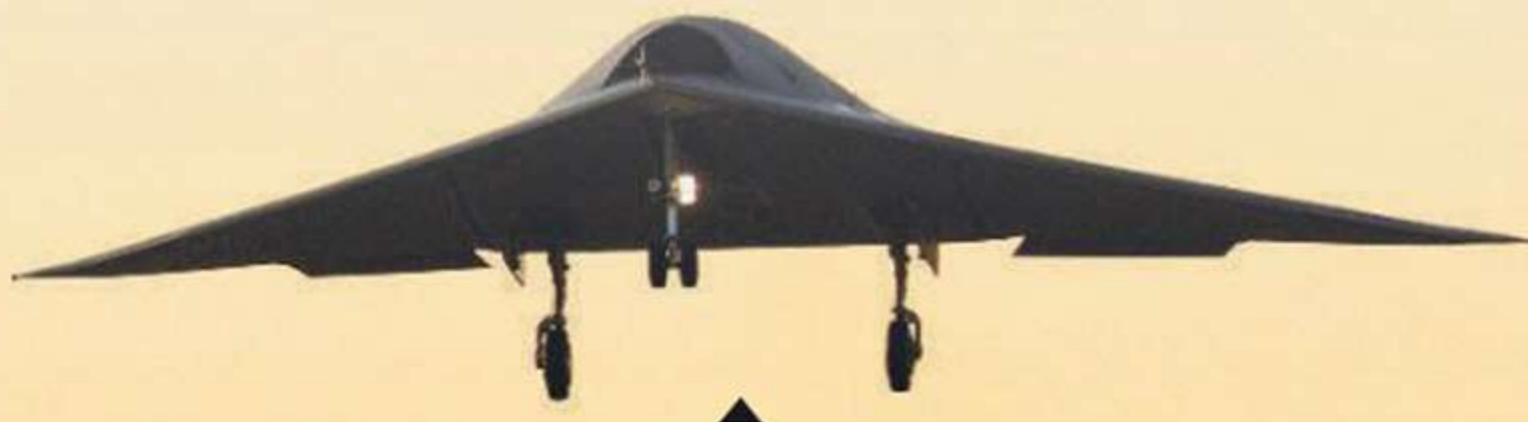
Le prototype Neuron de Dassault Aviation a une géométrie qui le rend furtif.
