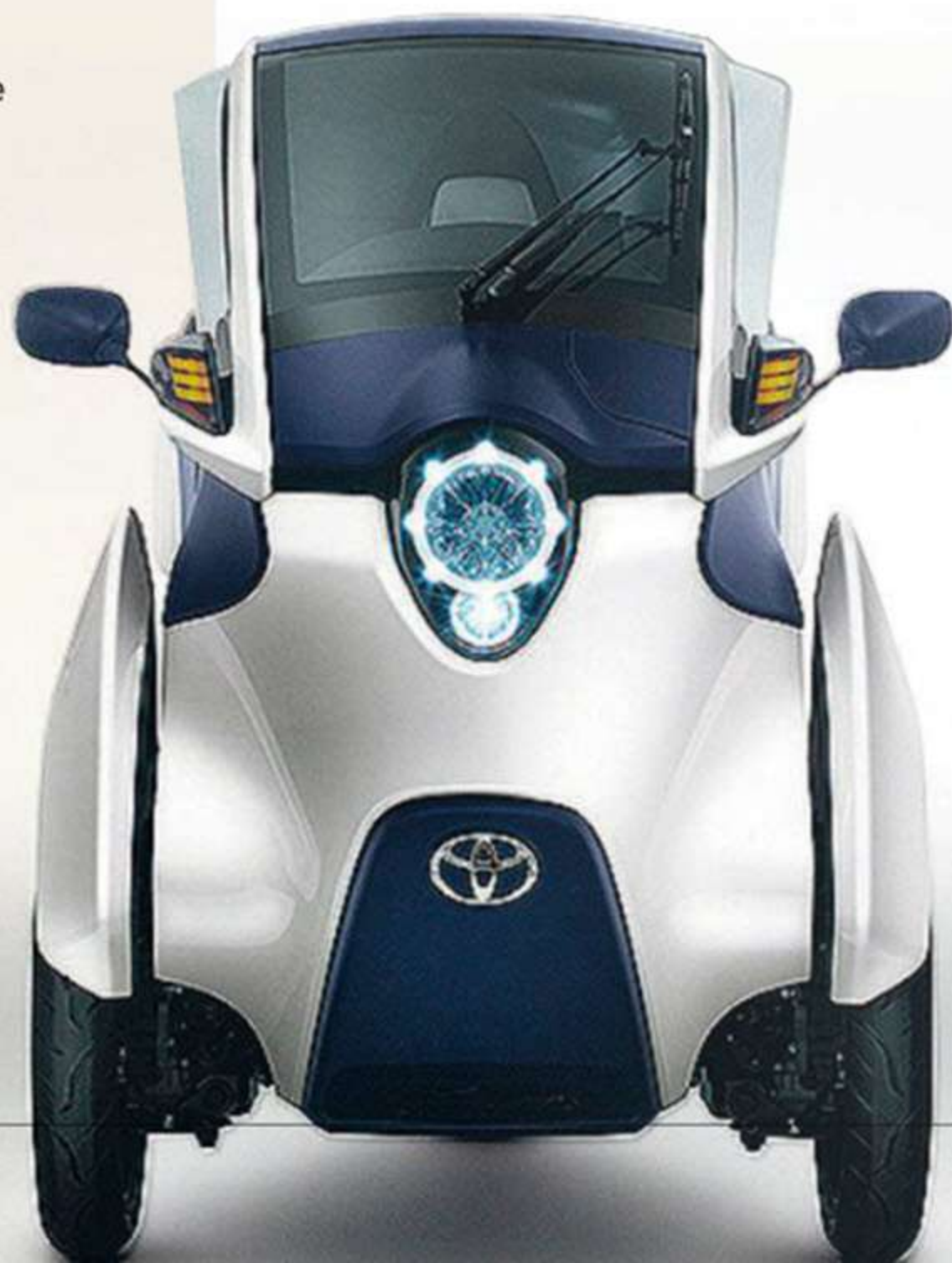
L'i-Road de Toyota s'incline sur ses roues avant dans les virages et peut tourner presque sur place.
